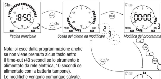
Nota: si esce dalla programmazione anche se non viene premuto alcun tasto entro il time-out (40 secondi se lo strumento è alimentato da rete elettrica, 10 secondi se alimentato con la batteria tampone). Le modifiche vengono comunque salvate.
